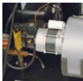
Enfasmotor ansluten till fläkt och dieselpump.
