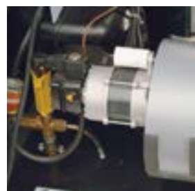
En-faset motor koblet til vifte og dieselpumpe.
